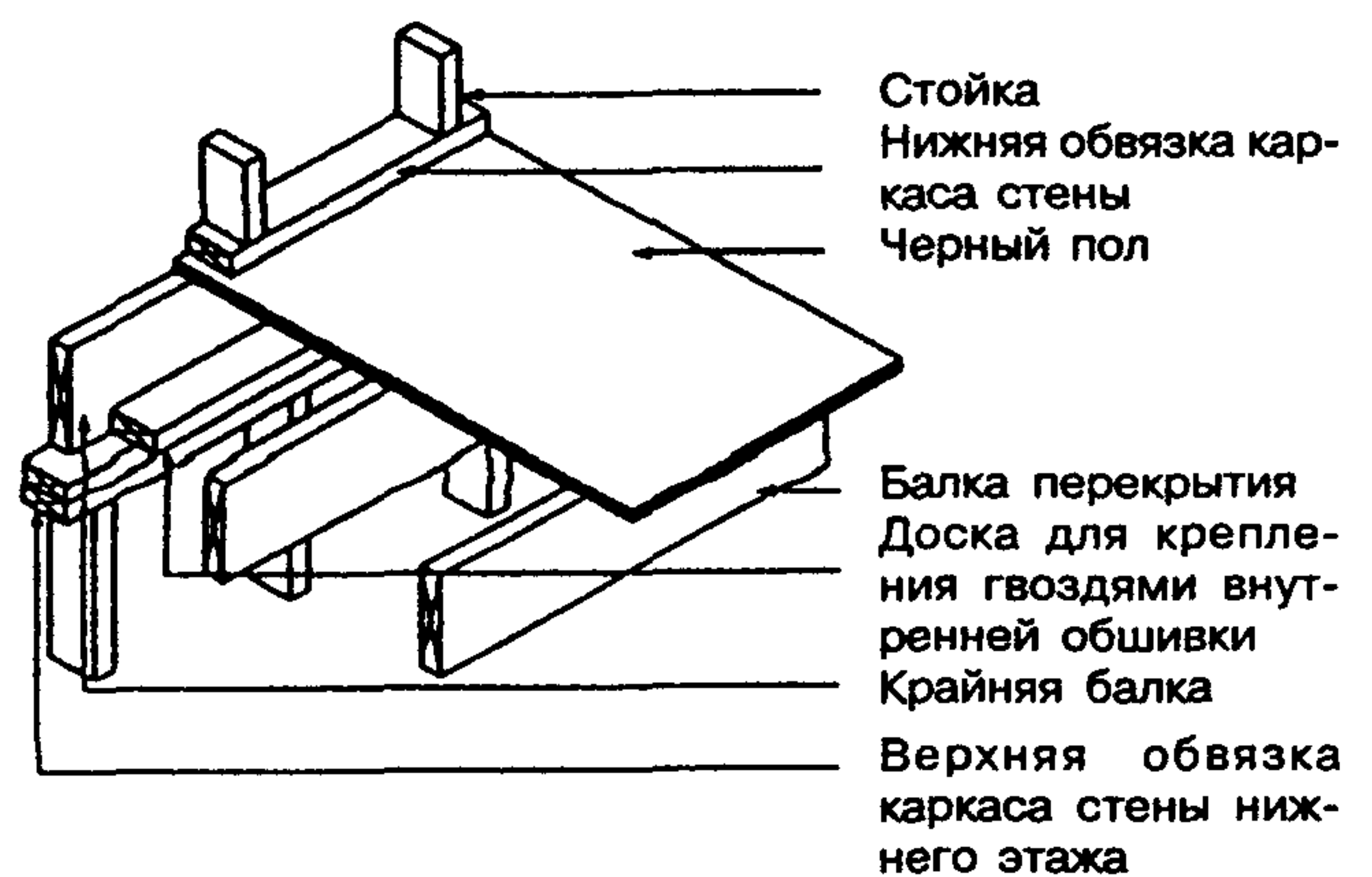
Рисунок 7-4 — Деталь установки доски для крепления внутренней обшивки
